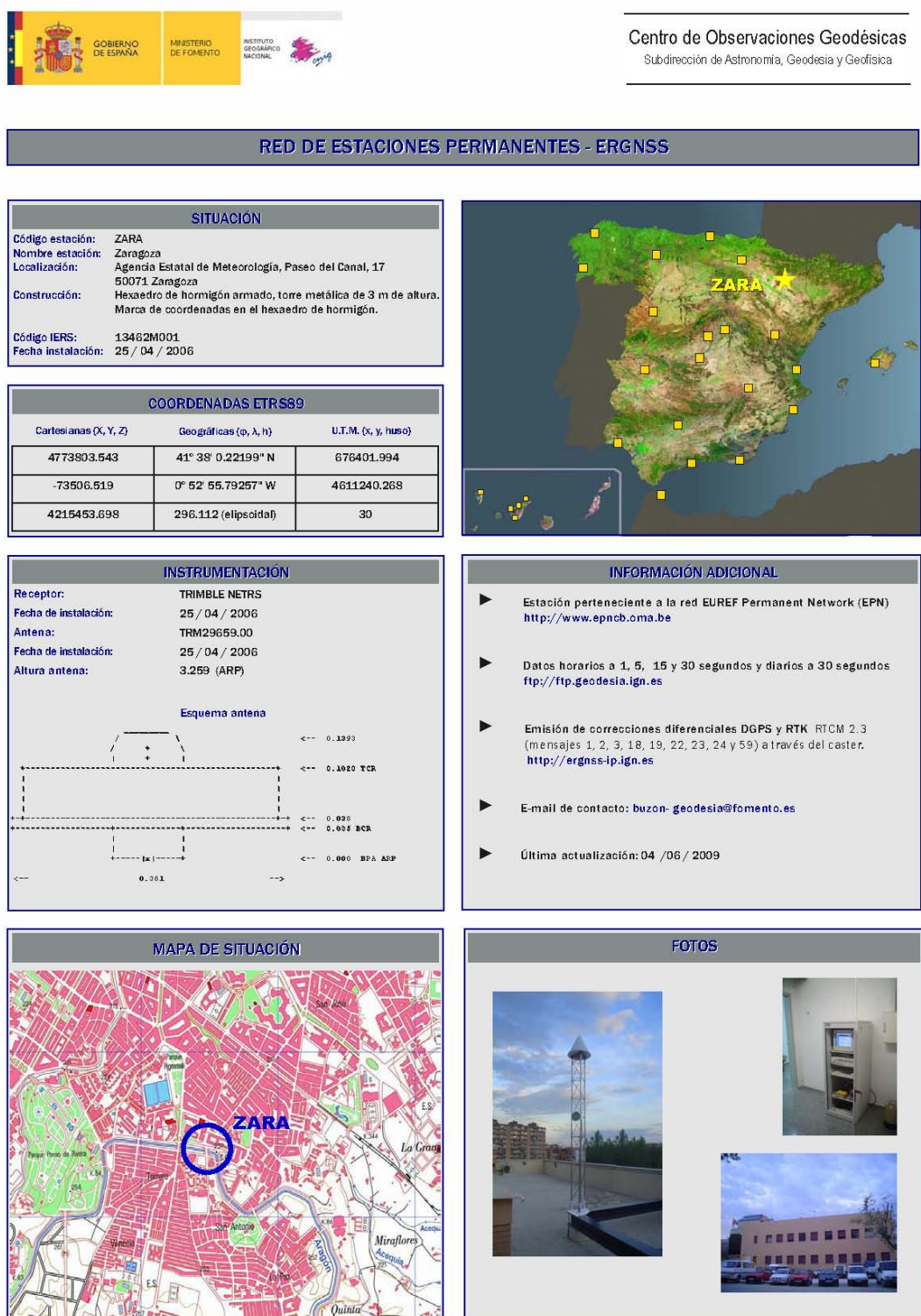
Figura 1. Reseña de la estación permanente del IGN en Zaragoza.
