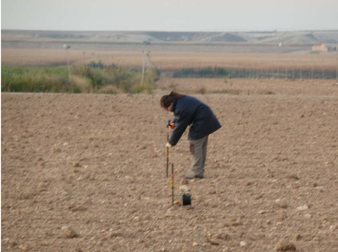
Fig. 3.5 Colocación de electrodos en un SEV
